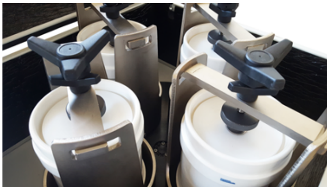
Particolare alloggiamento giarre Jars housing view
